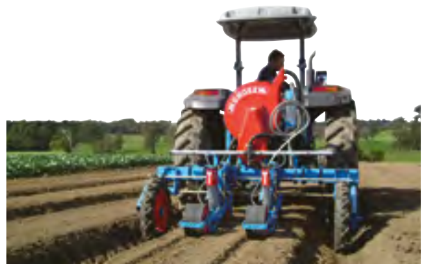
MS C Planter - Monobar rigid frame - 2 rows
