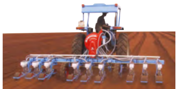
MS A planter - Rigid monobar frame - 3 x 3 rows
