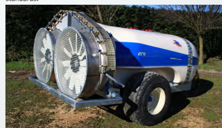
» **BITURBO 896** con 2 convogliatori indipendenti, inclinazione idraulica e ventole contro-rotanti è la soluzione ideale per vegetazione alta e con grandi distanze interfilari come noccioli.
